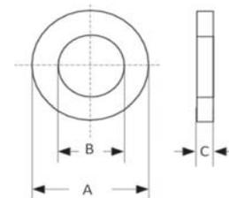
**SPESORE PER ASSE COMPRESSORE**
